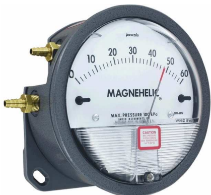
Příklad analogového diferenčního tlakoměru (Dwyer Magnehelic)
